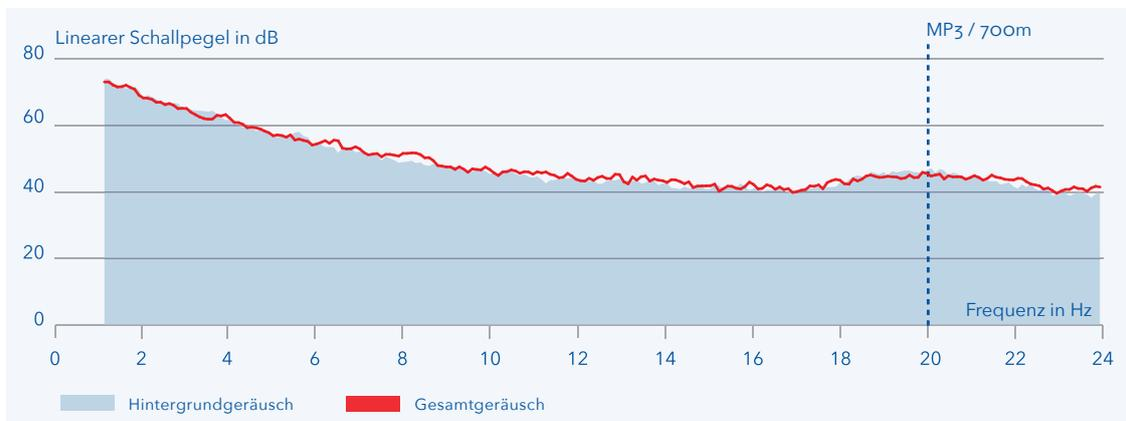
Abbildung 3: Eingeschaltete 2 MW-WEA mit Hintergrundgeräusch in 700 m Entfernung (Quelle: Daten des LUBW Zwischenberichts Messprojekt 2013-2014, Seite 17, eigene Darstellung)
